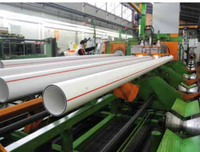
Bild 1: Fertigung mit Muffenanformung. Photo 1: Exécution avec préparation des manchons. Foto 1: Allestimento con formazione manicotto.
