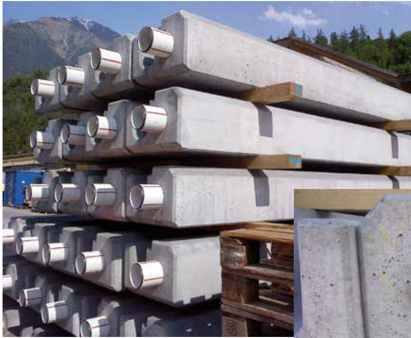
Bild 6: Innenliegende Verbindungsmuffe. Photo 6: Manchon de raccordement intégré. Foto 6: manicotto di collegamento interno.
