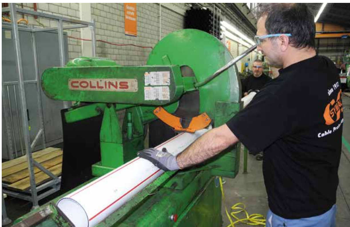
Bild 2: Exaktes Ablängen auf Speziallänge. Photo 2: Sectionnement exact aux longueurs spéciales. Foto 2: taglio preciso a lunghezza speciale.
